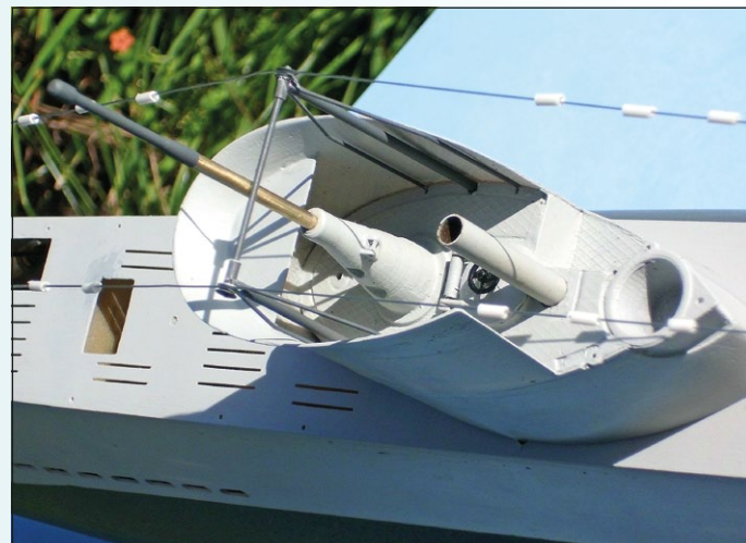
Vyústění odvzdušňovací trubice se nachází na věži ponorky hned vedle makety útočného periskopu
