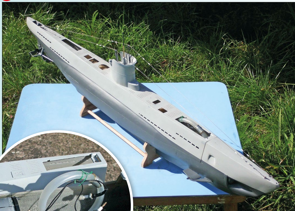
Rozestavěný model ponorky Vesikko se smyčkou hadice umístěnou těsně pod palubním krytem. V detailu smyčka původní plastové hadice.
