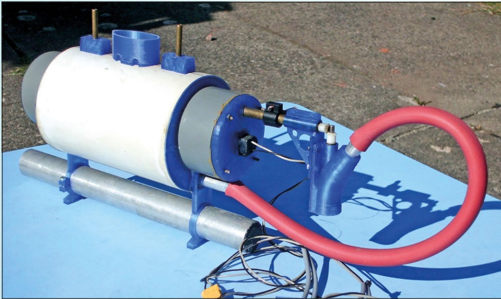
Axiální čerpadlo, v detailu uložení vrtule spájené z mosazného plechu v jeho tělese z 3D tiskárny
