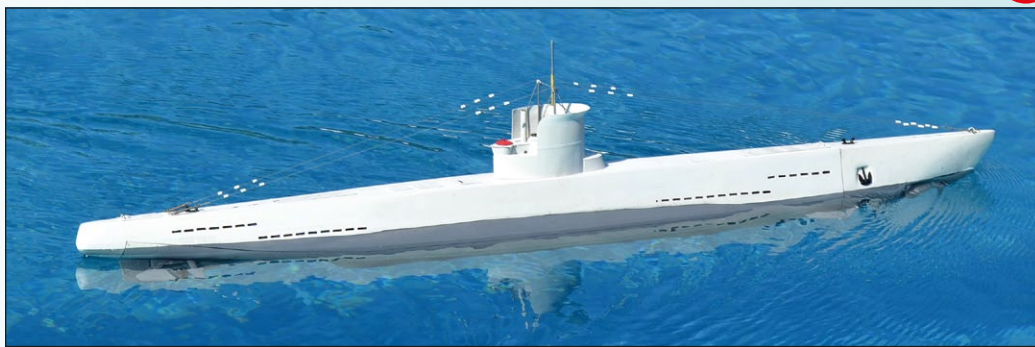
Vesikko po vyčerpání balastní nádrže o objemu zhruba půl litru
