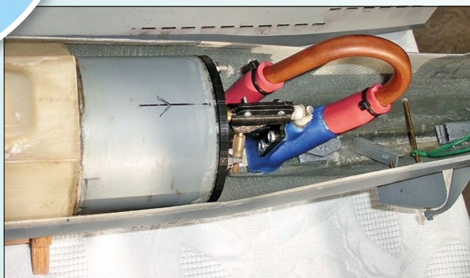
Vertikální uspořádání čerpadla ponorky Vesikko s měděným potrubím
