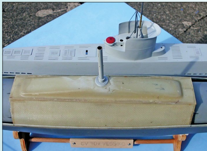
Detail nástavce laminátové balastní nádrže ponorky Vesikko s odvzdušňovací trubicí
