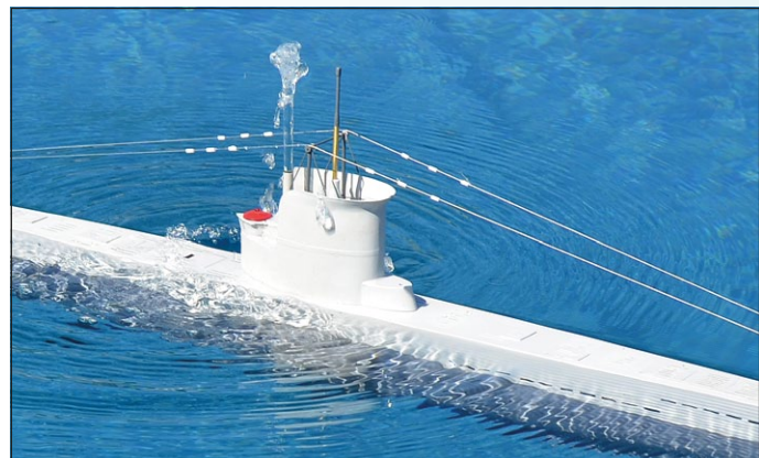
Vesikko po vyčerpání balastní nádrže o objemu zhruba půl litru
