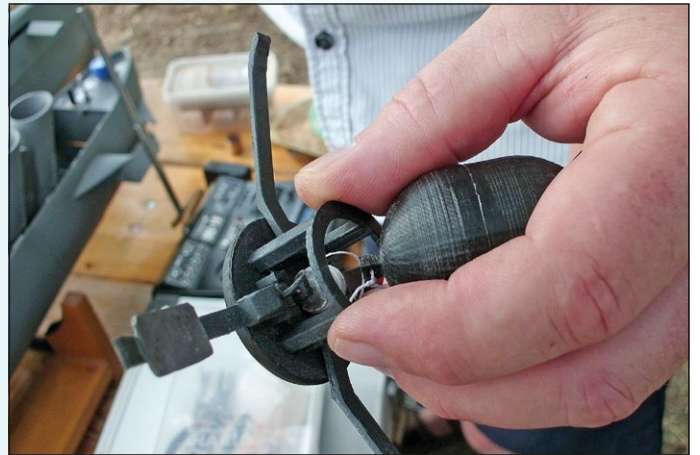
Model ponorné minonosky UC-4 Marcela Pollera z Německa. Vpravo mina s kotvou se čtyřmi výklapnými rameny, vlevo v detailu tři funkční šachty pro miny.
