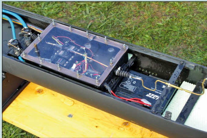
Zleva ventily ovládní ponořovacího systému Vanguardu, přední suchý box, akumulátor a nad ním ovládní předních kormidel
