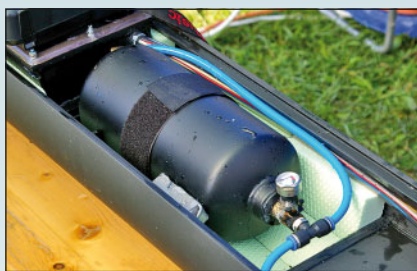
Nádrž na stlačený vzduch, před ní balastní nádrž
